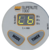
Batteria scarica Mettere il manipolo in carica!
