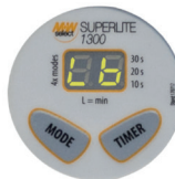
Gyenge akkumulátor Tegye fel a kézdarabot töltéshez!
