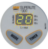
Il timer lampeggia batteria scarica 5-10% di carica!
