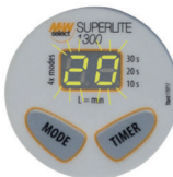
Az időzítő villog Alacsony az akkumulátor töltöttségi szintje 5-10%-os töltöttség!
